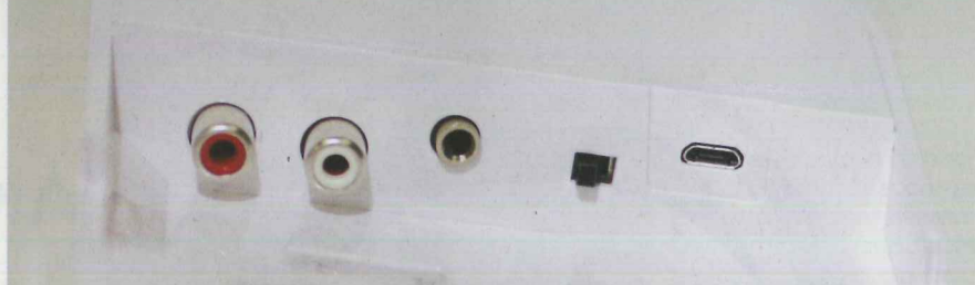
Dettaglio della zona ingressi, con la coppia di pin RCA affiancata dal mini-jack stereo da 3,5 mm. Seguono lo switch per una attenuazione fissa di 10 dB, e la presa microUSB per il collegamento dell'immane caricabatterie.
